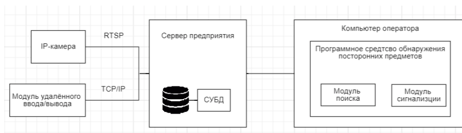
Рис. 1. Архитектура АС ОПП
