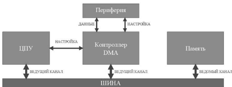
Рис. 3. Схематическая структура связи DMA, периферии и памяти в микроконтроллере
