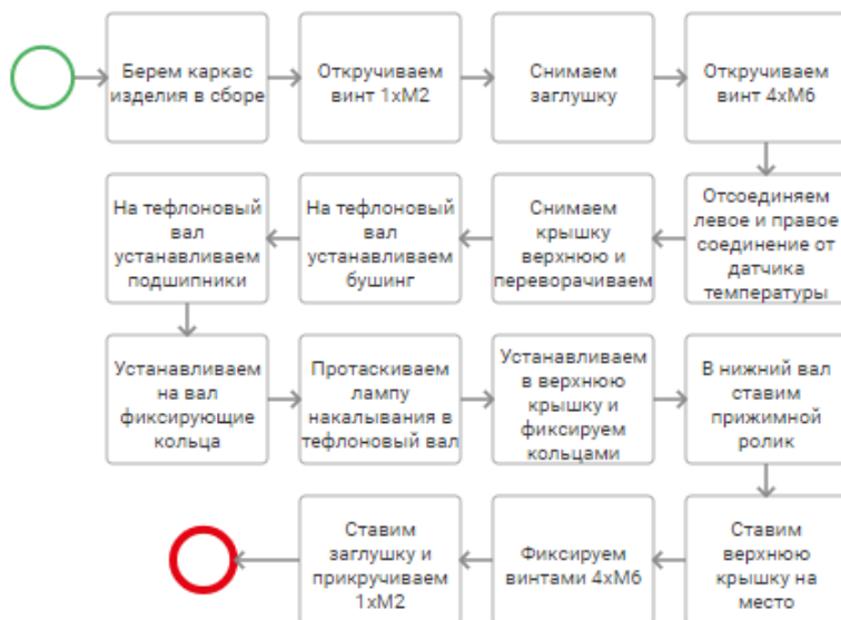
Рис. 2. Схема сборки FK3100X3
